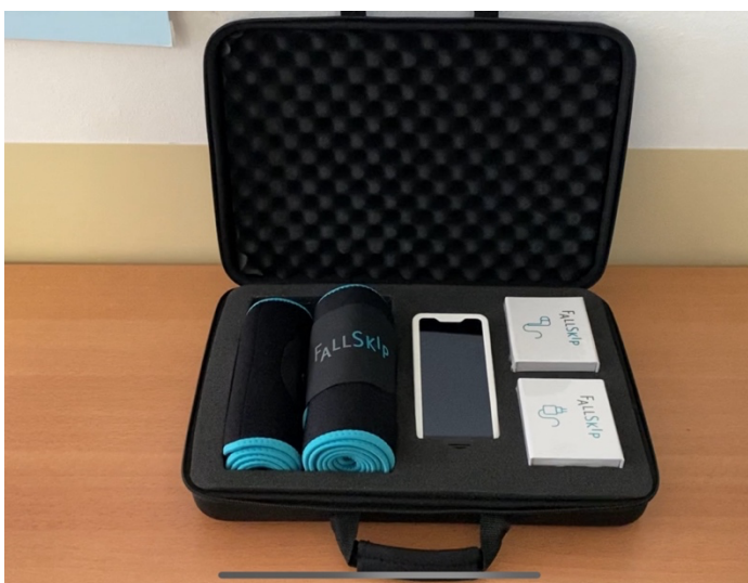
Zdjęcie 4. Kompletny zestaw Fallskip® składający się z pasa do mocowania, telefonu z zainstalowaną aplikacją, zestawu słuchawkowego dla osób z niedosłuchem oraz kabla do ładowania
