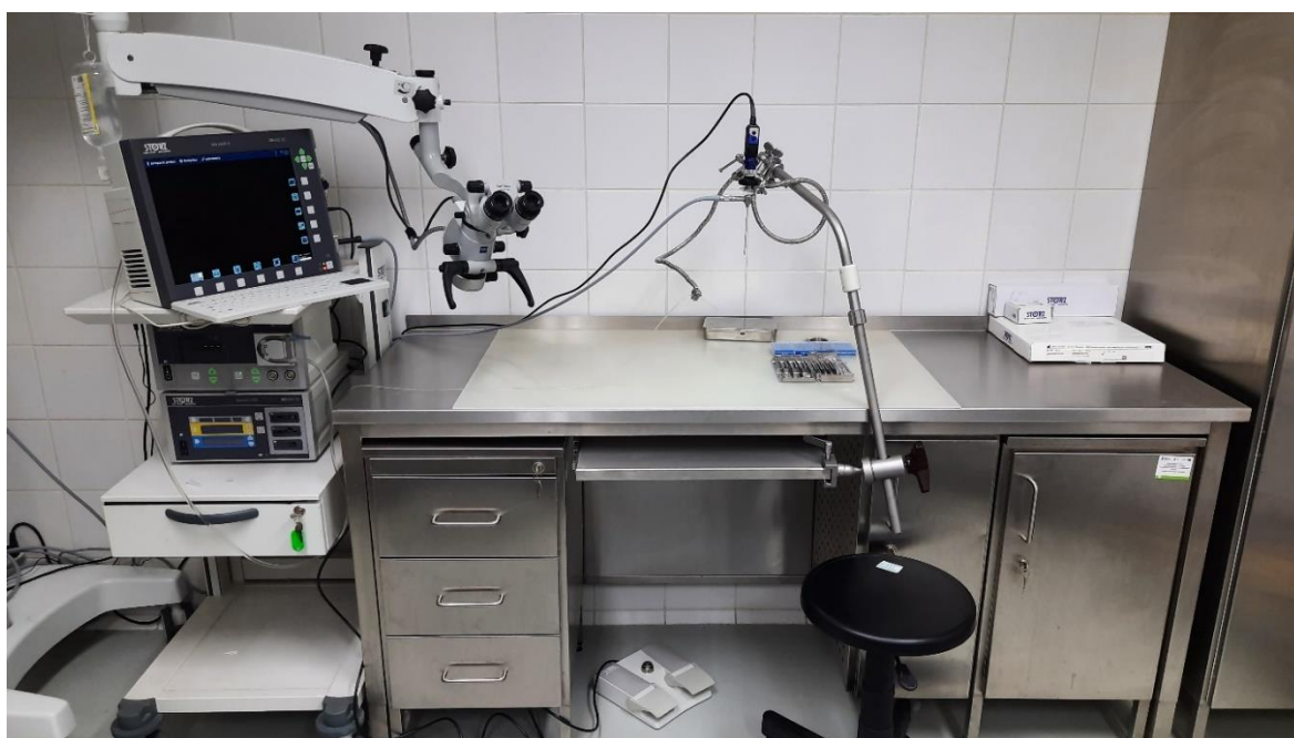
Ryc. 9 Stanowisko badawcze, w skład którego wchodzi m.in. mikroskop operacyjny, endoskop z zestawem płuczącym, narzędzia mikrochirurgiczne.
