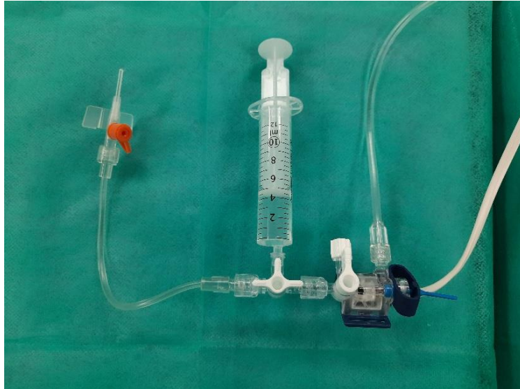
Ryc. 12 Układ doświadczalny użyty do pomiaru ciśnienia nastrzykiwania.
