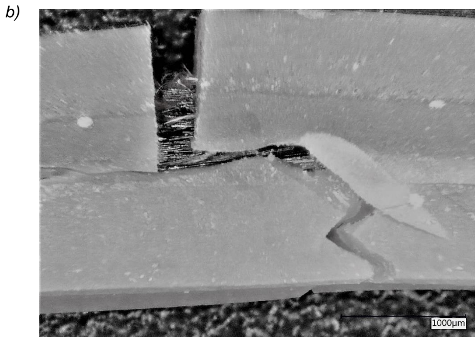
Ryc. 17. Wyniki testu zginania trójpunktowego próbek grupy WGL-AMD 1: a) wykresy siły w funkcji odkształcenia, b) postać zniszczenia próbki, powiększenie 100-krotne.
