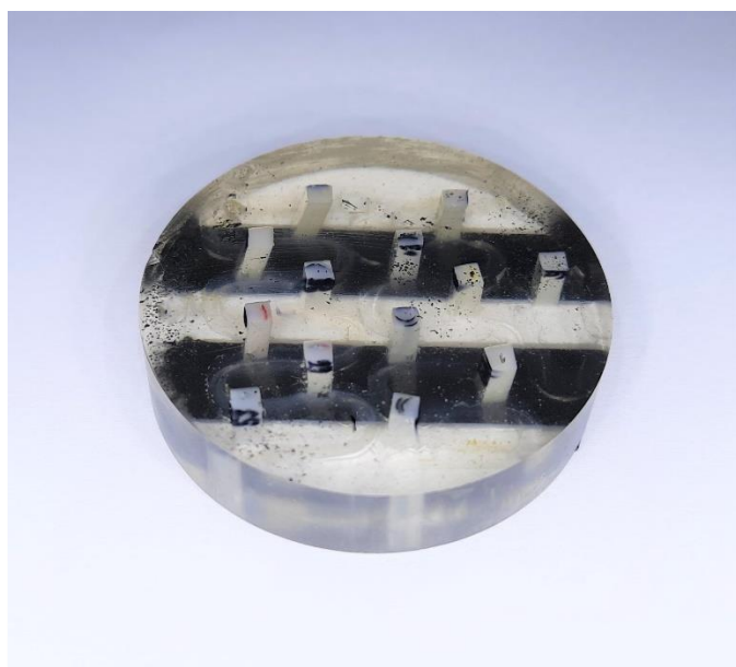
Fot. 10. Forma z próbkami z przyklejoną od spodu taśmą węglową przygotowana do obserwacji w SEM.
