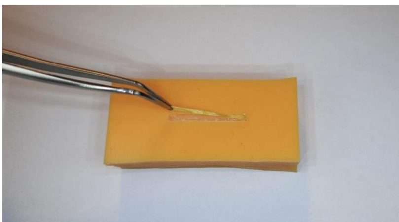
Fot. 6. Umieszczenie wiązki włókien na pierwszej warstwie kompozytu.
