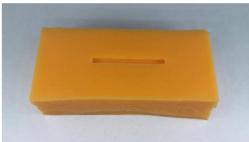
Fot. 2. Silikonowa forma (negatyw) wykonana na podstawie metalowego wzorcowego prostopadłościanu służąca do wykonania próbek.
