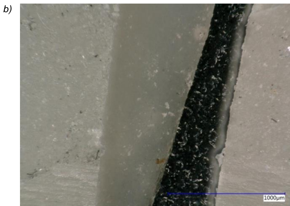
Ryc. 11. Wyniki testu zginania trójpunktowego próbek grupy KONT:
