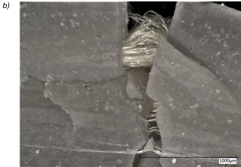
Ryc. 20. Wyniki testu zginania trójpunktowego próbek grupy AMD 2:
