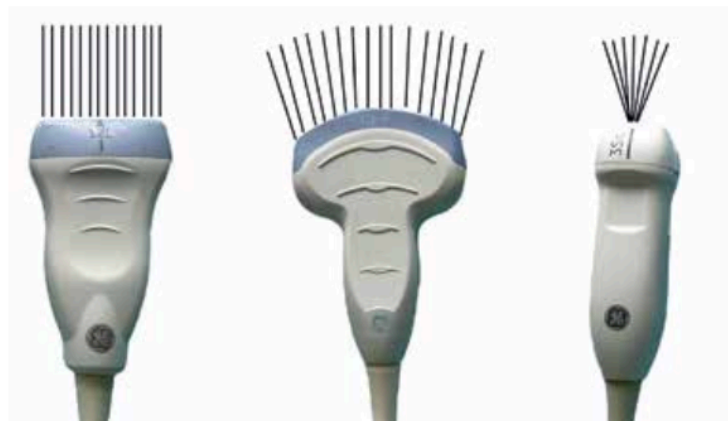
Ryc. 1. Schemat przedstawiający kształt wiązki ultradźwiękowej emitowanej przez poszczególne głowice. Od lewej: głowica liniowa, głowica konweksowa, głowica sektorowa
